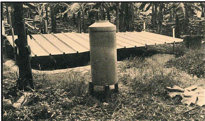
Pluviographe et case ERLO pour l'Etude du Ruissellement et du Lessivage Oblique
