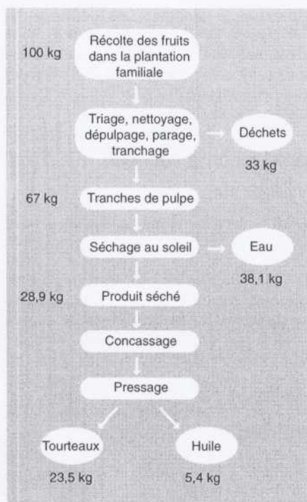
Figure 1 Schéma des principales étapes de la production d'huile de safou, effectuée de façon artisanale à l'échelle familiale ou villageoise.
