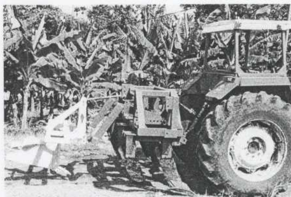
Photo 5. Combiné décompacteur - sillonneuse.
