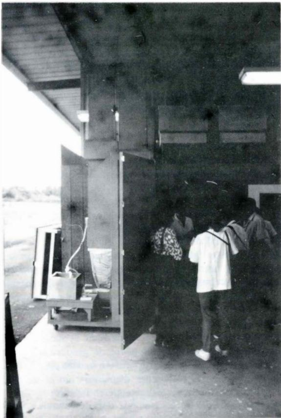
**Photo 7** - Laboratoires de l'USDA, Université des Hawaii à Hilo : mise au point de la tour-soufflerie pour la désinfection des papayes par courant d'air chaud forcé. L'air est pulsé, réchauffé et légèrement humidifié en montant dans la partie gauche, puis accéléré et redescend dans la partie droite où sont placés les fruits.
