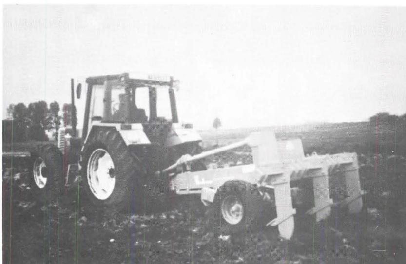
sent soit des sous-soleuses, portée 3 points, très simples à fabriquer, soit des corps simples ou des barres porte-outils (TOOL-BAR) à plusieurs corps : doubles, triples avec dispositif en ligne, en V ou en delta, chacun disposant de socs à ailettes et d'obus draineurs.
