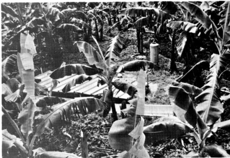
Photo 3. Étude de la lixiviation en bananeraie. Vue générale de la case de drainage.
