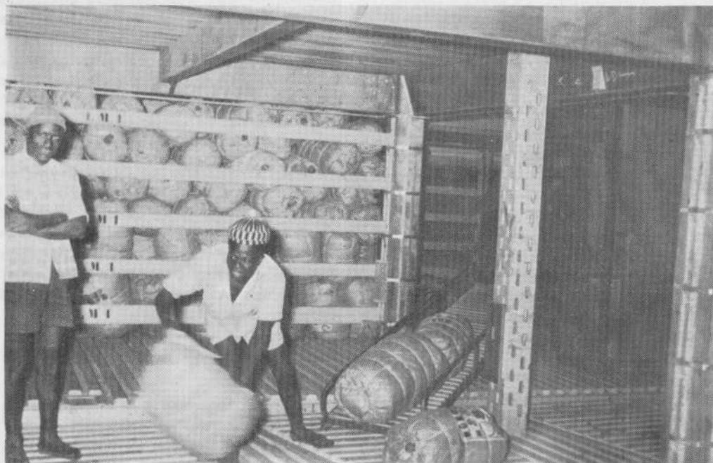
7 - Compartiment de cale d'un navire à ventilation horizontale avec pères constitués par des potelets et des madriers pour le calage des régimes de bananes (photo R. Deullin).
