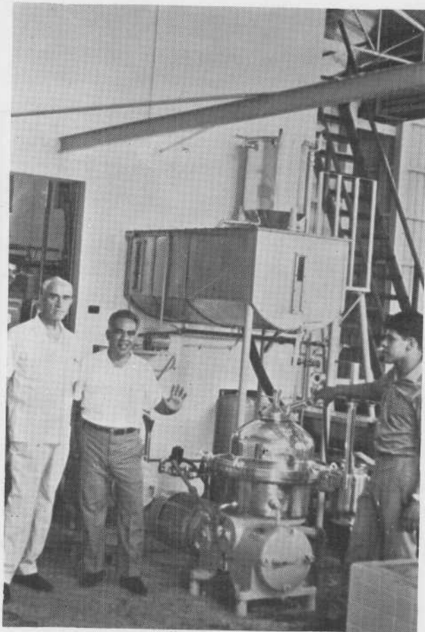
Préparation d'essence centrifugée. Bac à jus et centrifugeuse (Etat de Colima).
