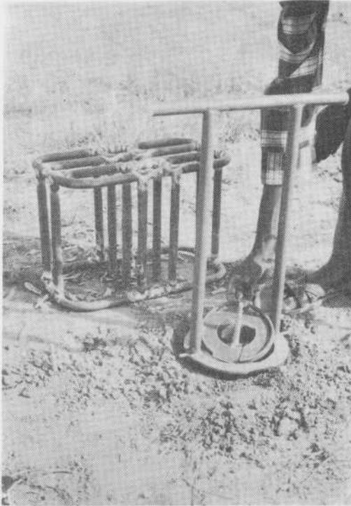
Photo 6 - Pose du disque de tôle autour du jeune plant, à l'intérieur de la déplantreuse.
