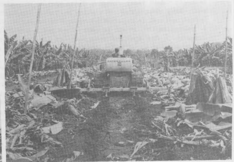
Photo 7 - Sous-solage dans la partie central du grand intervalle.
