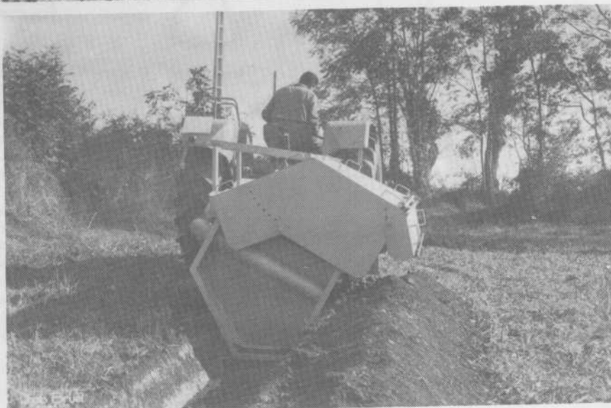
Photo 4 - Appareil à façonner les drains (photo communiquée par EXCAROTOR).
