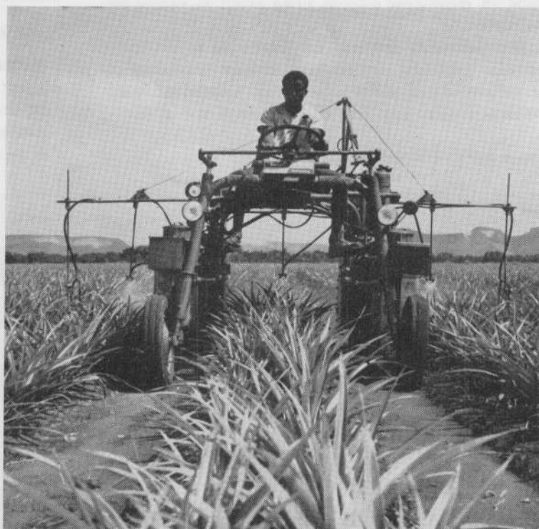
PHOTO 11. — Traitement avec tracteur enjambeur muni de rampe latérale.
