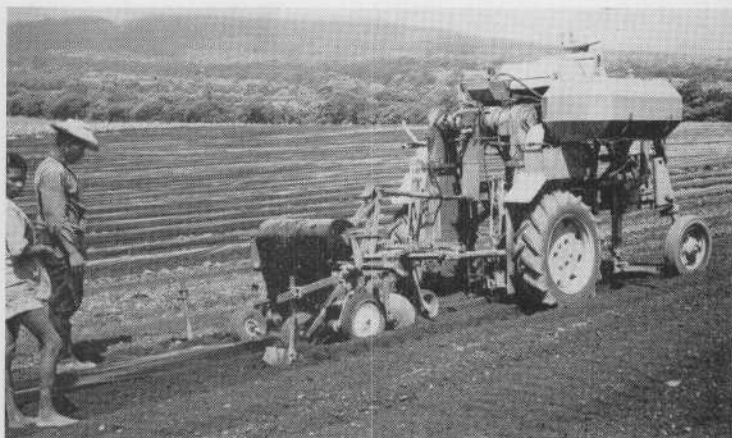
PHOTO 3. — Le tracteur enjambeur et le dérouleur de poly font les 5 opérations suivantes sur une bande : épandage engrais, épandage nématicide, formation du billon, déroulement du film de poly et recouvrement des bords.
