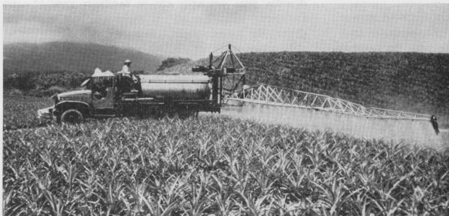
PHOTO 12. — Traitement avec rampe portée à main d'homme en Martinique, la rampe de pulvérisation est reliée à la pompe et à la citerne par un tuyau souple.
