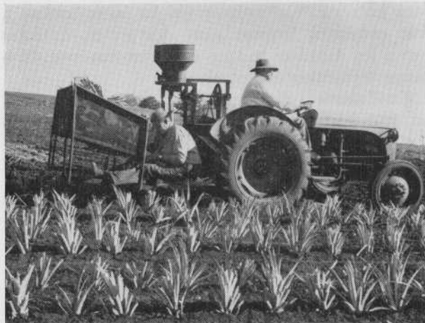
PHOTO 7. — Mise en terre des rejets par un appareil mis au point en Australie, il permet de planter 7 000 rejets à l'heure à 3 ouvriers mais l'approvisionnement en rejets reste difficile ; dans les appareils les plus perfectionnés on adjoit un épandeur d'engrais.
