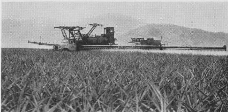
PHOTO 14. — Vue 3/4 d'un « boom-sprayer » à 2 rampes latérales au moment où il s'apprête à être réapprovisionné par un camion citerne sans pour cela qu'il y ait interruption dans l'application de la solution.
