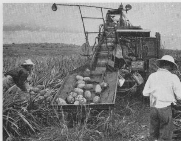
PHOTO 20. — Élévateur mécanique utilisé pour le chargement des camions.
