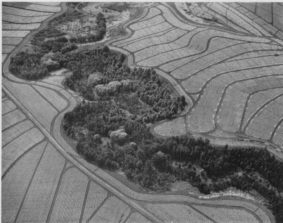
PHOTO 1. — Vue aérienne d'une plantation en courbe de niveau à Hawaï. La largeur des bandes correspond à 2 fois la longueur des rampes des appareils de pulvérisation et des machines à récolter.
