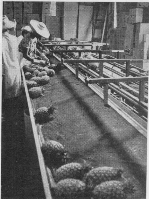
PHOTO 25. — Triage par bandes caoutchoutées divergentes.
