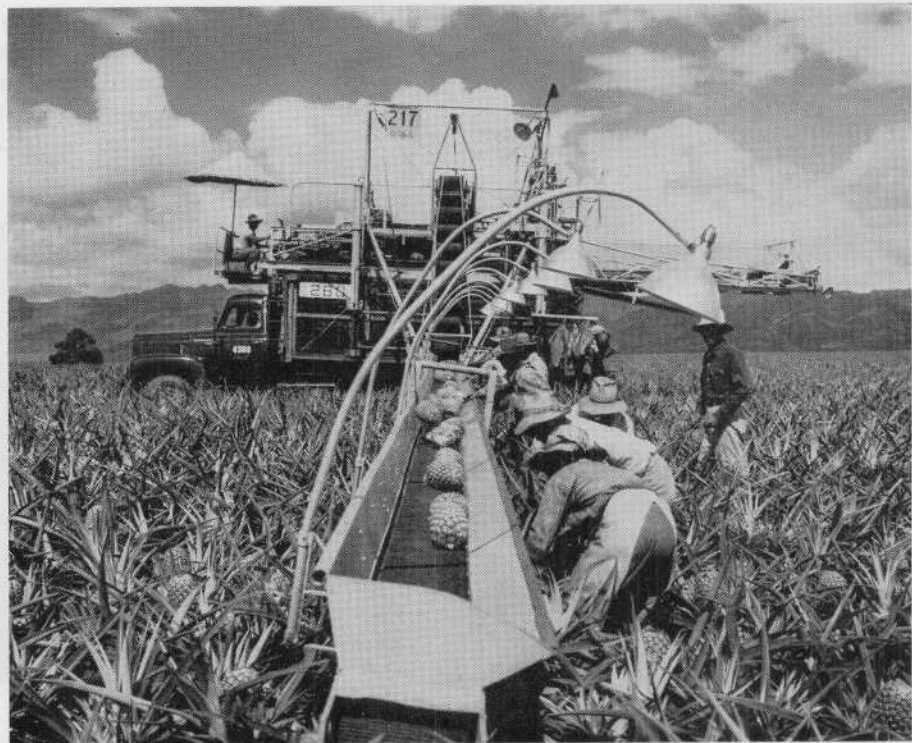
PHOTO 17. — Détail de convoyeur latéral qui se déplace devant les ouvriers.
