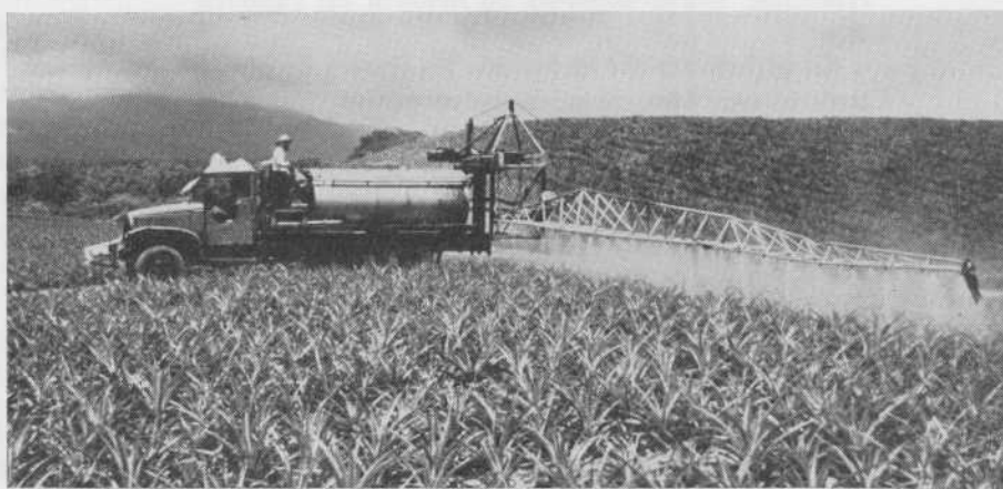
PHOTO 7. — Application d'herbicide sur l'ensemble de la végétation à l'aide d'une rampe de pulvérisation « boom sprayer ». (Photo C. Py).
