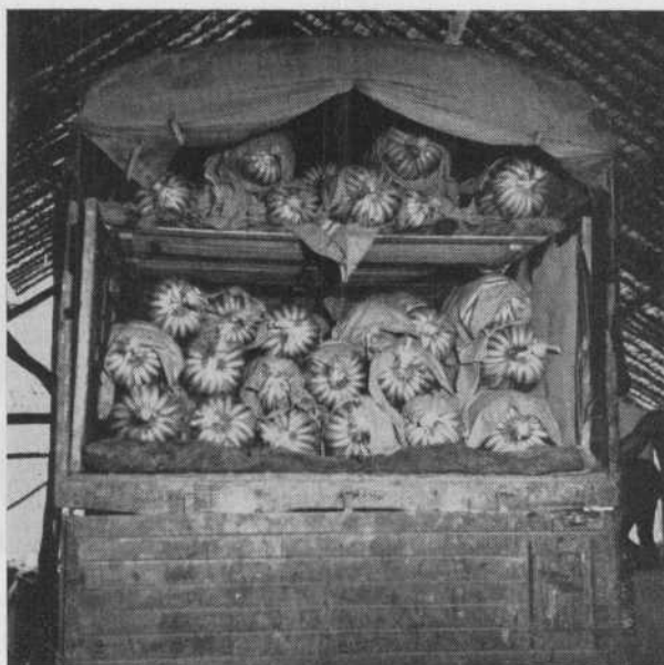
PHOTO 3. — Camion pourvu d'un plancher intermédiaire pour le transport des régimes de la plantation jusqu'à l'atelier (Ph. Hughes, Madagascar).
