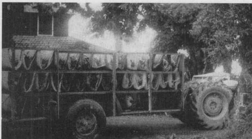
PHOTO 4. — Remorque pour le transport en « hamacs » des régimes, système Agromeca, Martinique.
