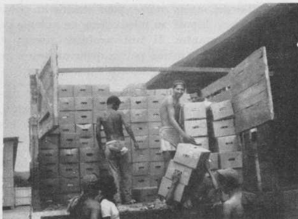
PHOTO 2. — Transport routier des cartons de 12 kg à Guayaquil (Équateur). Remarquer le « flambage » de certains cartons.
