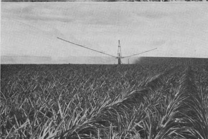
PHOTO 7. — Vue 3/4 du « boom-sprayer » à 2 rampes utilisé actuellement dans certaines grandes plantations hawaïennes. Cet appareil est capable de traiter 20 ha par jour en appliquant 3 000 litres de liquide à l'ha.
