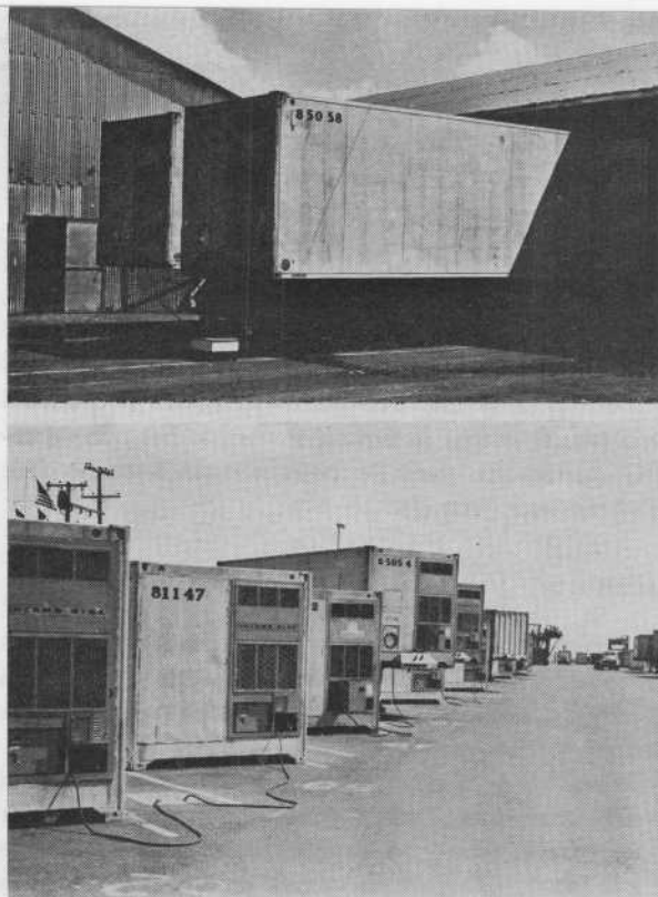
PHOTO 13. — Containers munis de leur propre unité de réfrigération attendant leur chargement à la station d'emballage.
