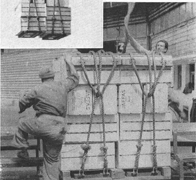
PHOTO 8. — Détail de la pose du harnais équipant les deux demi-palettes sur la palette de transport. (Photo Comelli I. F. A. C.)
