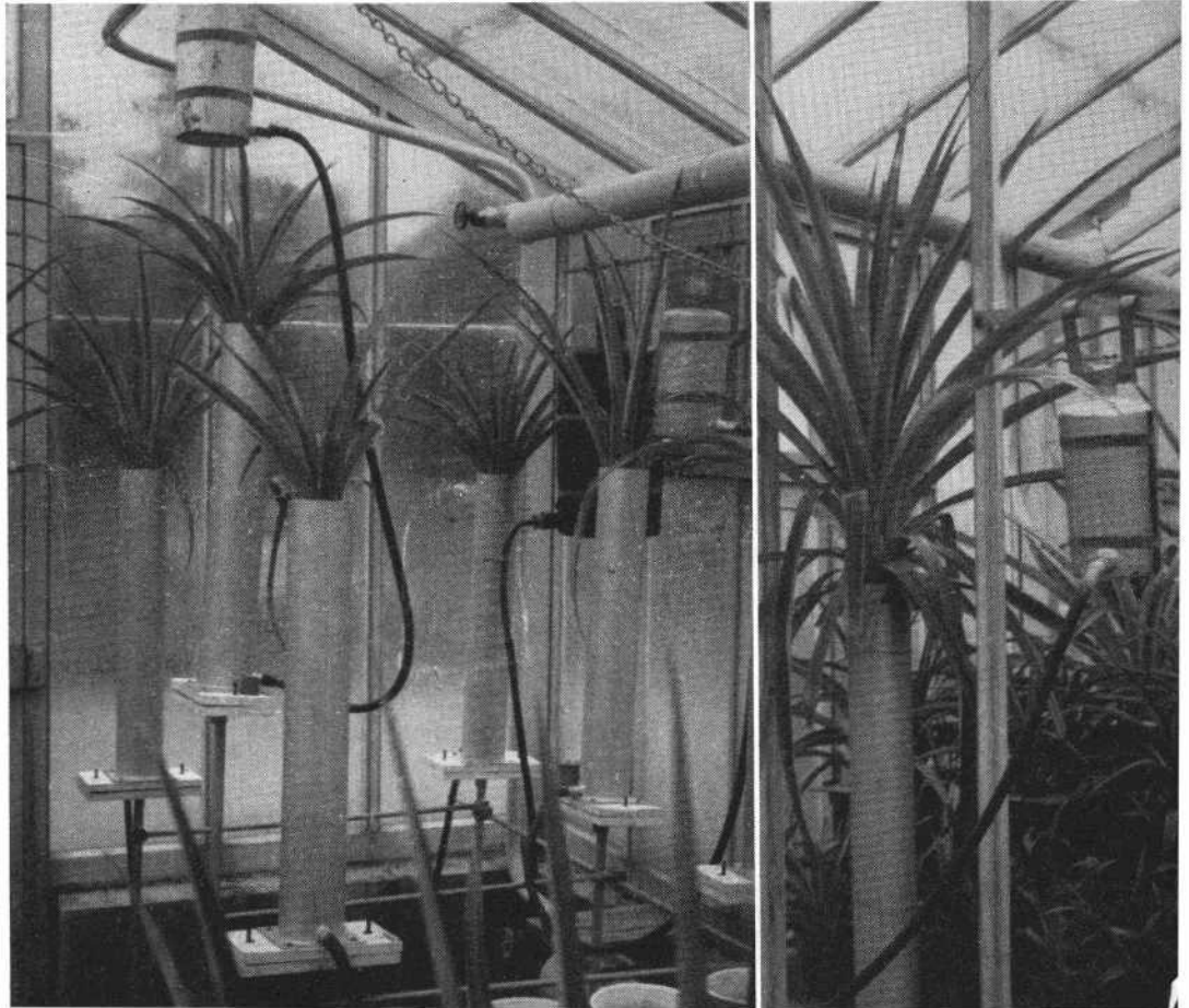
PHOTOS 9 et 10. — Culture par sous-irrigation en tube contenant un support de polystyrène sphérique.
