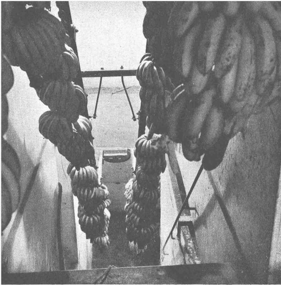
PHOTO 1. — Convoyeur à chaîne sans fin alimentant les chambres de maturation en sous sol.
