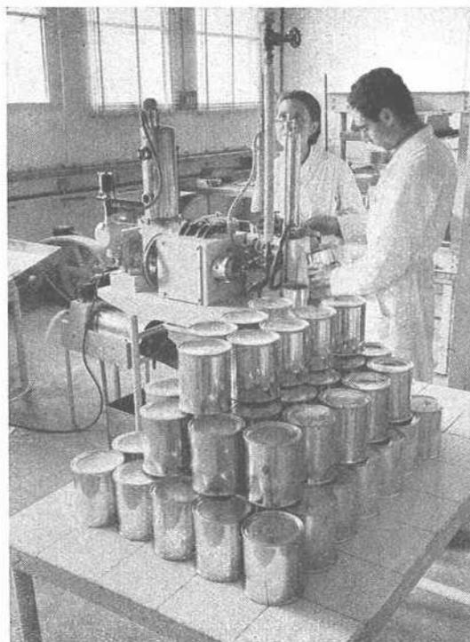
FIG. 4. — Pasteurisation du jus d'orange au moyen du Désaérateur-flash, pasteurisateur Rozé. (Photo B. Rouget, Casablanca.)
