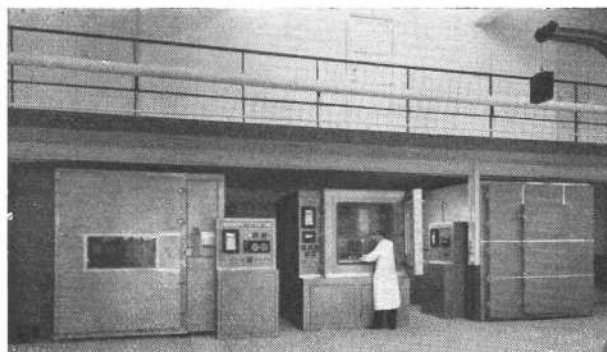
PHOTO 4. Laboratoire Général pour Emballages. Essais climatiques : de gauche à droite : la chambre humide (15 m 3 ) — le caisson tous climats (1 m 3 ) — la chambre froide (15 m 3 ) réglable de - 35° C à + 20° C.
