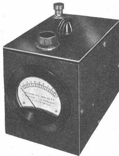
FIG. 12. — Appareil de Haynes utilisé pour la mesure de l'énergie germicide. (Photo Mazda.)
