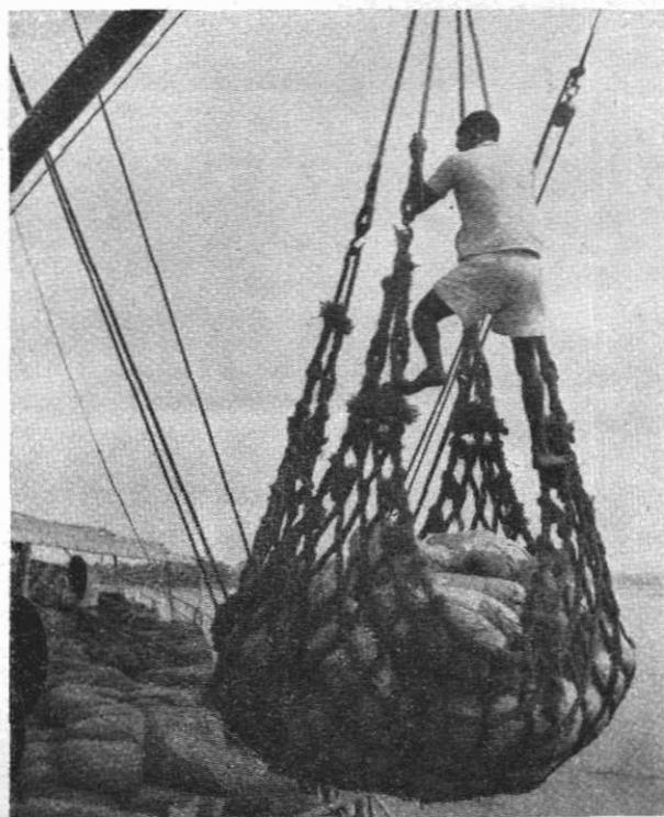
FIG. 12. — Manutention des emballages par palanquée (Photo Deullin, I. F. A. C.).
