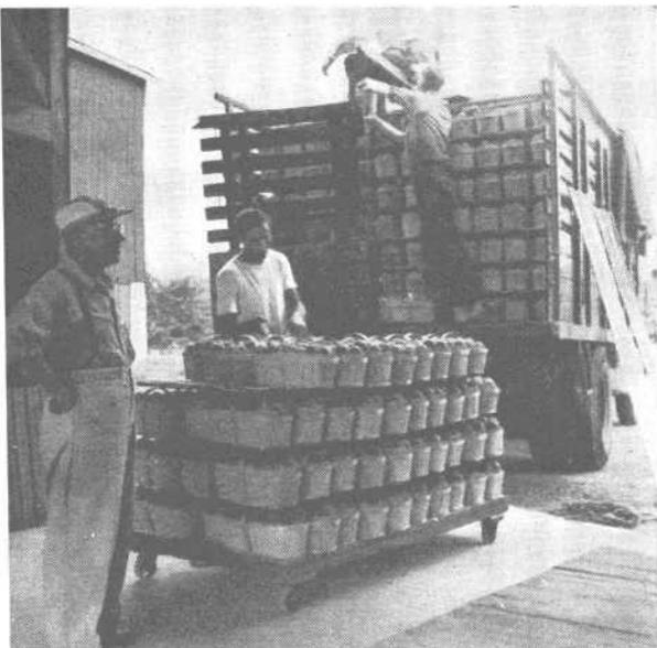
FIG. 6. — Chargement d'un camion de pêches en paniers. Remarquer l'empilage dans le camion : une grande rigidité de l'ensemble est donnée par des planches placées « de champ » entre les paniers.
