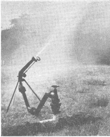
Fig. 7. — Arroseur à turbine dont le rayon d'action peut atteindre 30 mètres.
