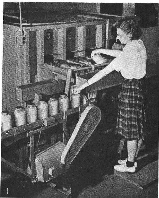
Fig. 3. — Introduction de bocaux de jus d'orange dans le congélateur Finnegan. (d'après Tressler D.K. et Evers C.F., 1946).
