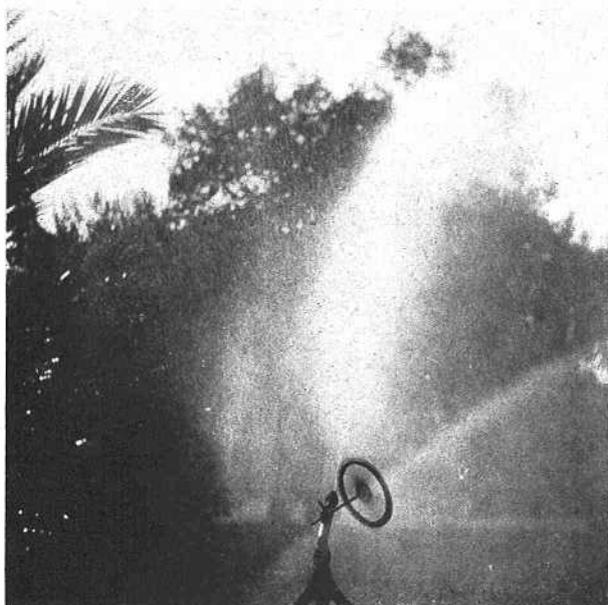
Fig. 1. — Arroseur tournant, montrant la dispersion du jet en fin brouillard.
