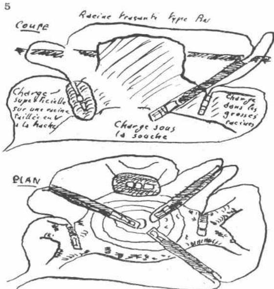
pour les charges intérieures utilisées si les arbres ont un diamètre  $\geq 0$  m. 50 on place la charge dans des trous creusés à la tarière, aux 2/3 de l'épaisseur (on bourre avec de la terre) — la charge est de :
