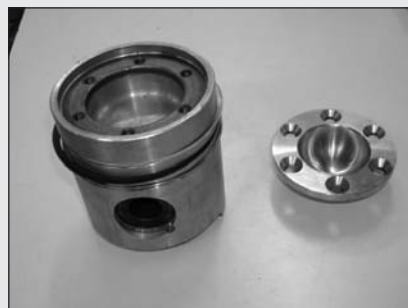
Conception CAO d'un piston de tracteur FIAT et réalisation (Cirad 1995)
