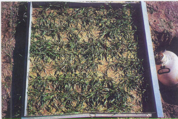
Photo 1. Placette expérimentale de 1 m 2 semée en blé dans le sens de la pente, destinée aux simulations de pluie.
