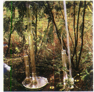
Photo 2. Infiltromètre à succion contrôlée.
