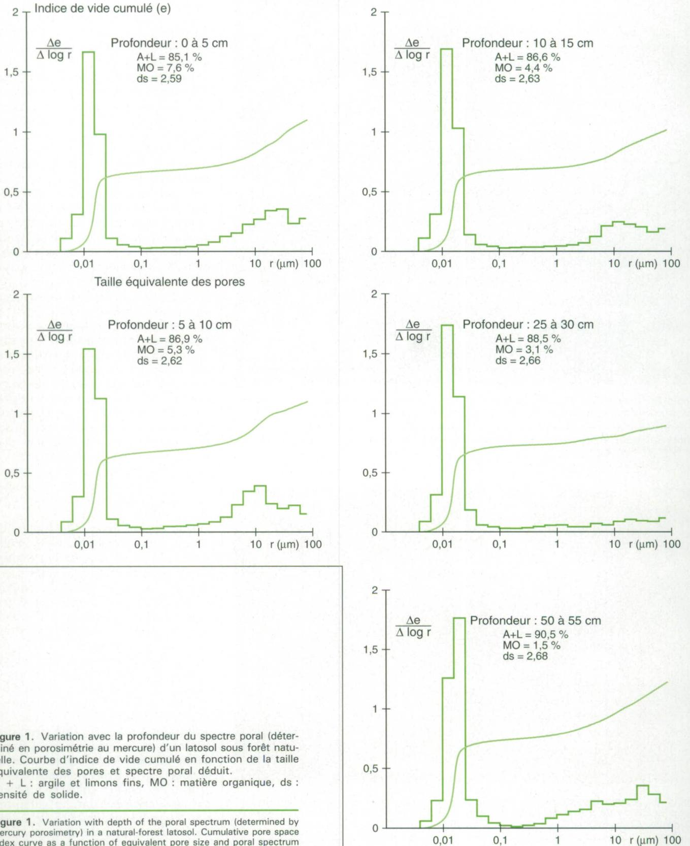
**Figure 1.** Variation avec la profondeur du spectre poral (déterminé en porosimétrie au mercure) d'un latosol sous forêt naturelle. Courbe d'indice de vide cumulé en fonction de la taille équivalente des pores et spectre poral déduit. A + L : argile et limons fins, MO : matière organique, ds : densité de solide.
