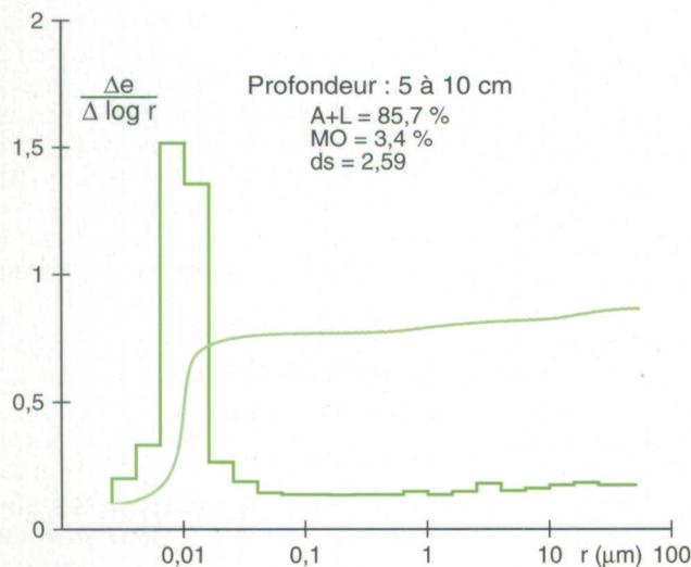
**Figure 3.** Variation avec la profondeur du spectre poral (déterminé en porosimétrie au mercure) d'un latosol sous pâturage depuis trois ans sur le domaine Fucada. Courbe d'indice de vide cumulé en fonction de la taille équivalente des pores et spectre poral déduit.
