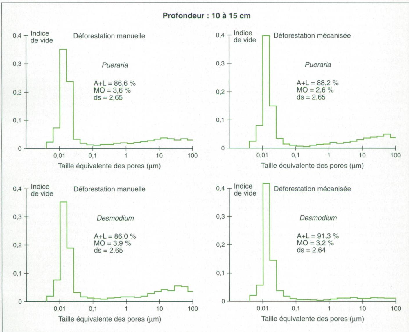
**Figure 5.** Comparaison du spectre poral (déterminé en porosimétrie au mercure) d'un latosol déforesté manuellement ou mécaniquement, et planté en *Pueraria* ou *Desmodium* (spectres moyens : 2 à 3 répétitions, un seul profil par parcelle). Plantation du Rio Urubu (EMBRAPA), profondeur : 10 à 15 cm.
