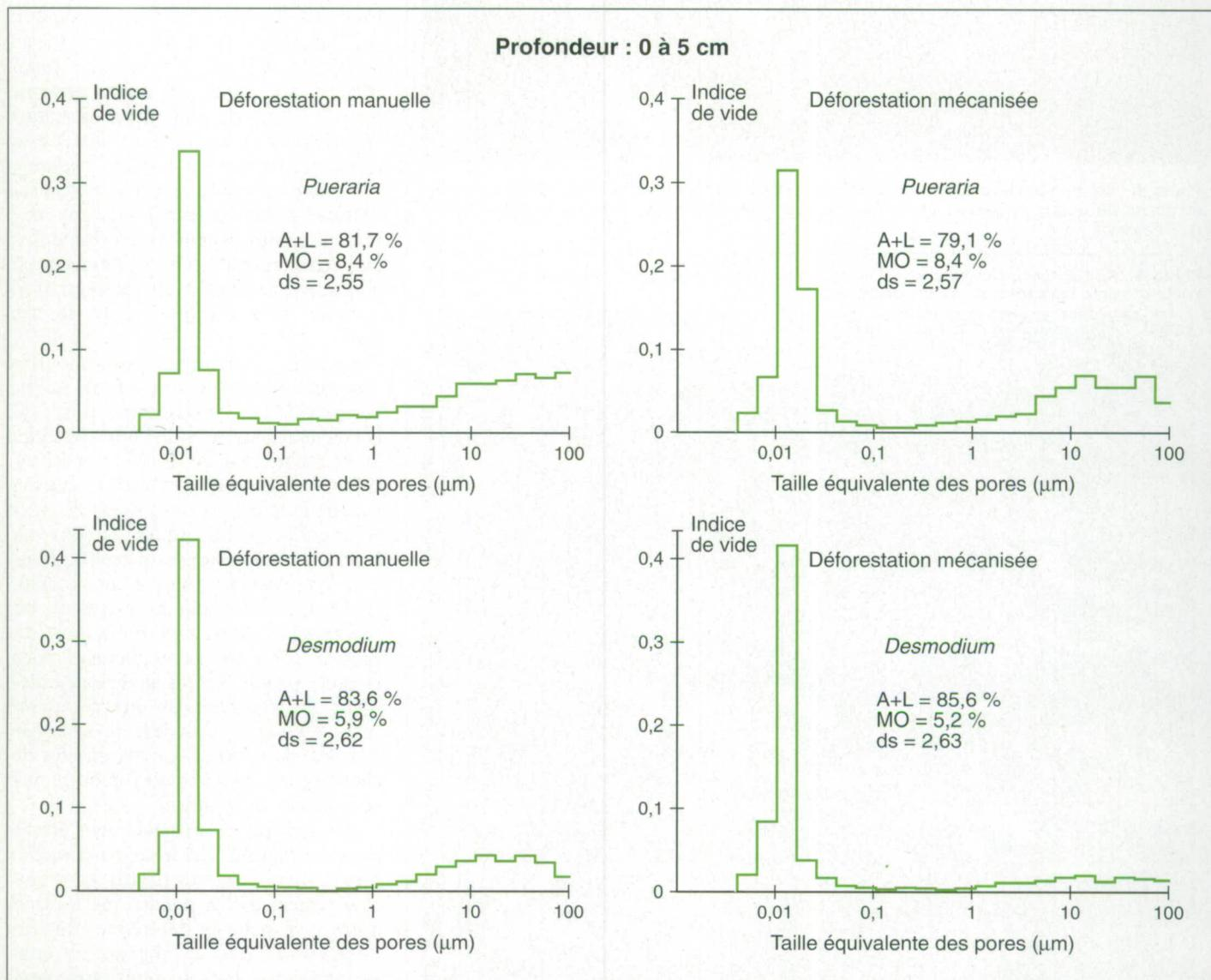
**Figure 4.** Comparaison du spectre poral (déterminé en porosimétrie au mercure) d'un latosol déforesté manuellement ou mécaniquement, et planté en *Pueraria* ou *Desmodium* (spectres moyens : 2 à 3 répétitions, un seul profil par parcelle). Plantation du Rio Urubu (EMBRAPA), profondeur : 0 à 5 cm.
