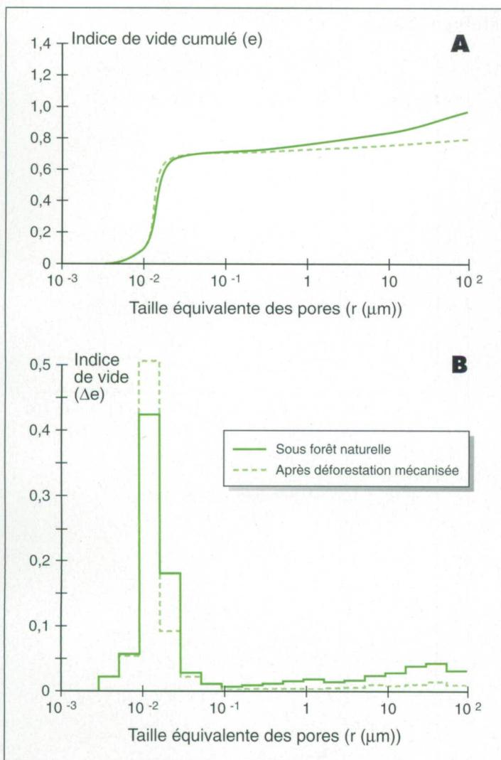
**Figure 2.** Effet d'une déforestation mécanisée sur le spectre poral d'un latosol. En porosimétrie au mercure, (A) courbe d'indice de vide cumulé en fonction de la taille équivalente des pores et (B) spectre poral déduit.
