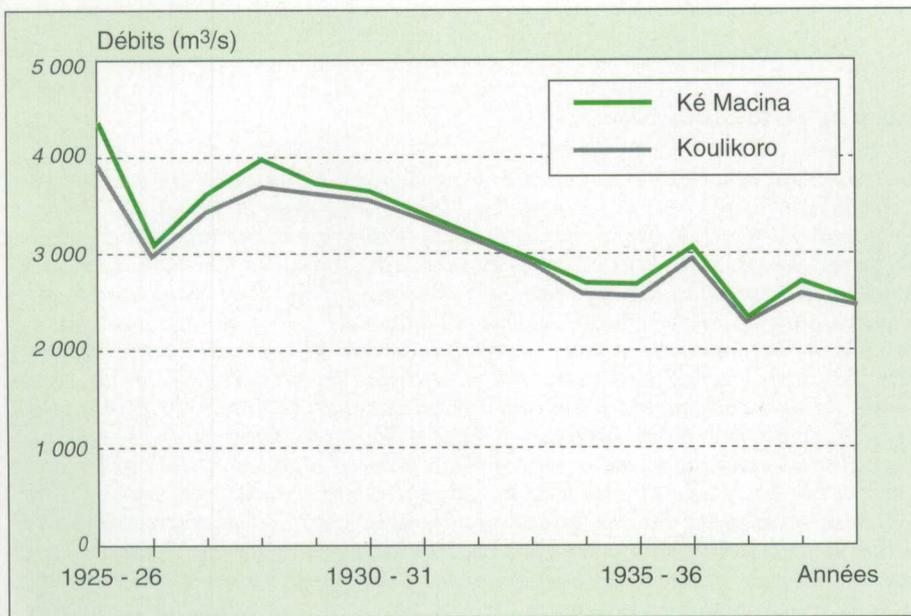
Figure 5. Débit moyens à la crue à Koulikoro et Ké Macina. La différence entre les deux stations correspond aux pertes par évaporation et infiltration.
