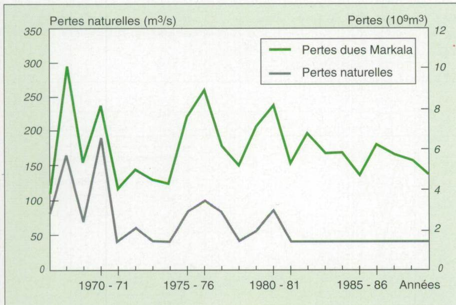
Figure 6. Pertes naturelles en eau et pertes dues au barrage de Markala entre les stations de Koulikoro et Ké Macina. A partir de 1980, les pertes naturelles sont fixées à 40 m<sup>3</sup>/s bien que les valeurs réelles soient certainement inférieures.
