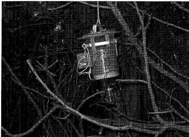
Figure 3 : piège à ultraviolets standard utilisé pour échantillonner les Culicoides.
