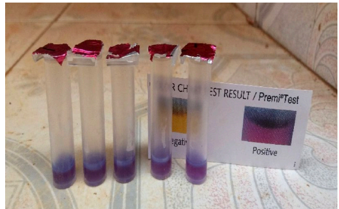
Figure 1 : PremiTest utilisé pour rechercher la présence de résidus d'antibiotiques dans les denrées alimentaires d'origine animale ; à gauche négatif ; à droite positif /// PremiTest used to test for antibiotic residues in foodstuffs of animal origin; left negative; right positive
