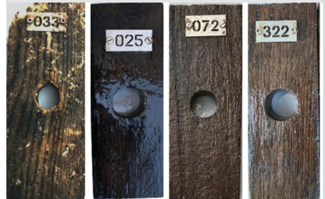
033: Pin sylvestre ( Pinus sylvestris ) après 1 an 025: Acaria ( Minquartia guianensis ) après 22 ans 072: Azobé/Ekki ( Lophira alata ) après 8 ans 322: Angélique ( Dicorynia guianensis ) après 6 ans
