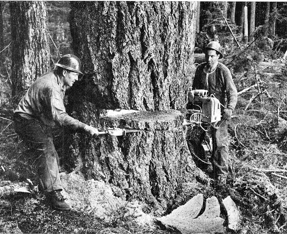
Entaille double à trois traits, côté chute de l'arbre. A noter les casques protecteurs obligatoires
