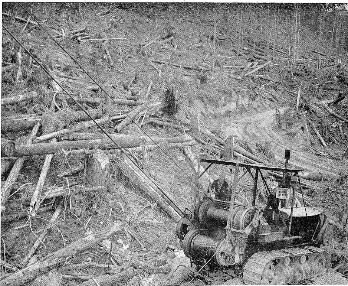
Moto-treuil monté sur tracteur « Highlead system »
