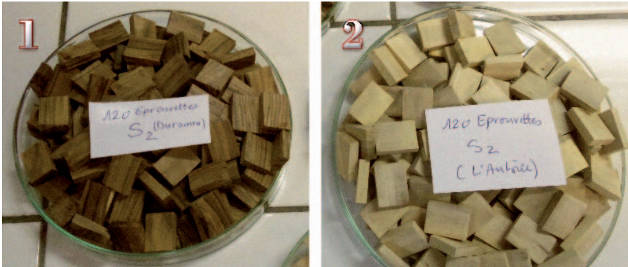
Photo 3. Éprouvettes de duramen (1) et d'aubier (2) du pistachier destinées aux tests de durabilité naturelle. Photos M. Boudouaya, 2012 au LERMAB de Nancy.
