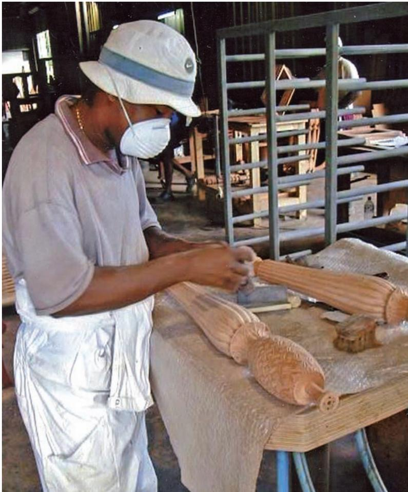
Ponçage d'éléments de mobilier avant d'appliquer une finition (Martinique).
