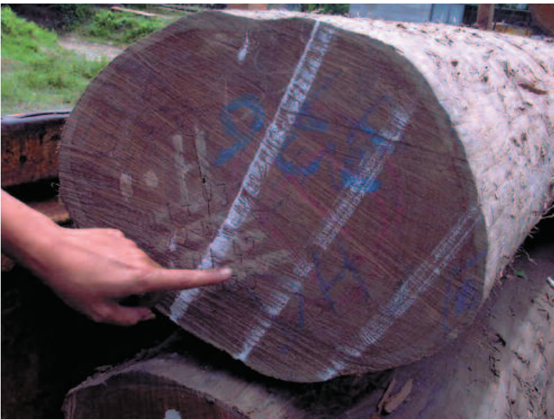
Billon de teck pour la fabrication de meubles d'exportation, avec numéros d'identification apposés au marteau. A log of teak for the manufacture of export furniture, with identification codes stamped with a hammer. Photo J.-M. Roda.
