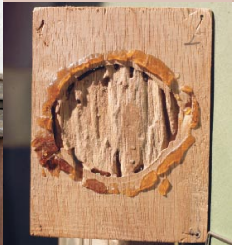
Photo 7. Éprouvette de chêne attaquée. Photo D. Fouquet.
