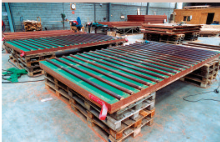
Pose en atelier du complexe absorbant maintenu par un grillage et un lattage. Photo M. Vernay.
