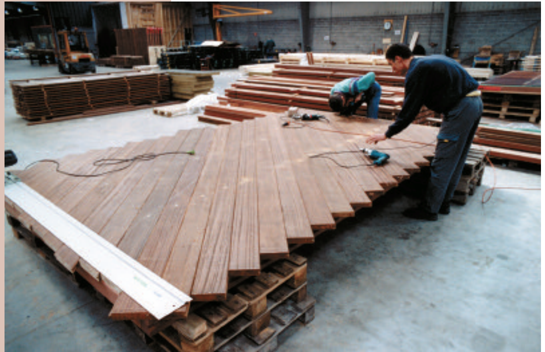
Fabrication des panneaux en atelier. Fixation des clins. Photo M. Vernay.
