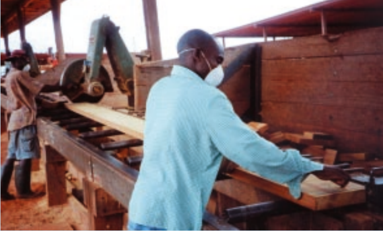
Marquage de la qualité des avivés avant l'éboutage. Gari Gombo, Cameroun. Quality stamping squared-off timber before butting. Gari Gombo, Cameroon. Photo F. Pinta.
