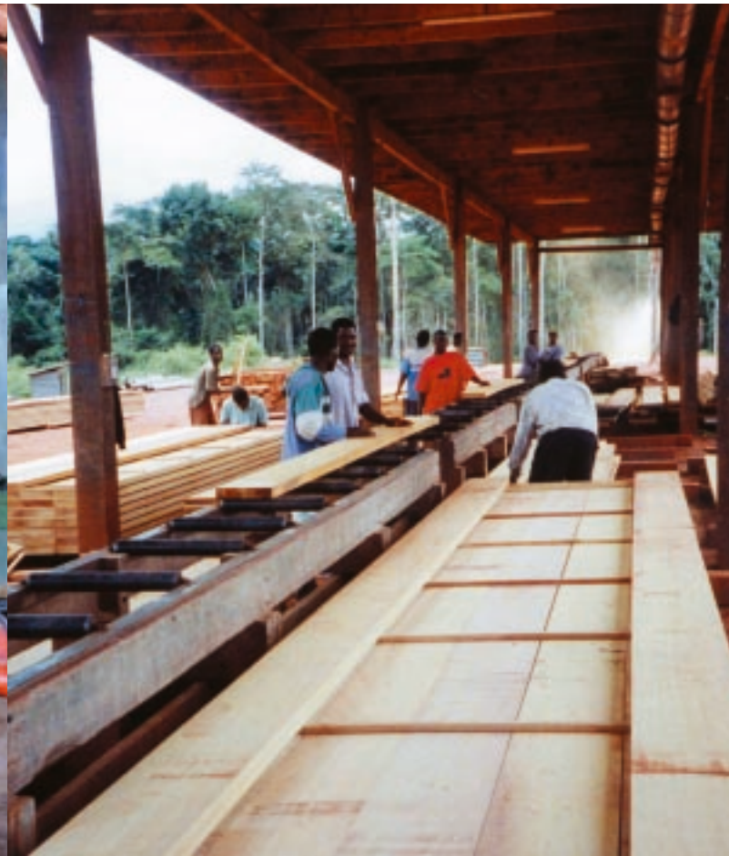
Ligne d'éboutage et empilage des avivés. Gari Gombo, Cameroun. Production line for butting and stacking squared-off timber. Gari Gombo, Cameroon. Photo F. Pinta.
