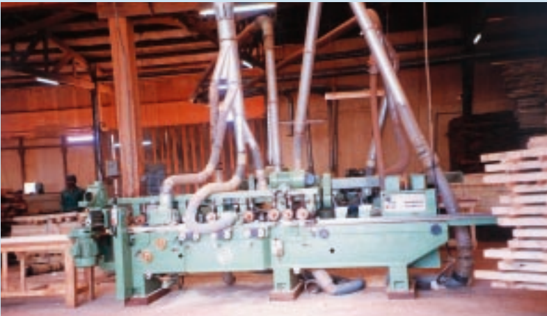
Exemple d'équipement de deuxième transformation : moulurière permettant neuf opérations. Libongo, Cameroun. Example of secondary processing equipment: a moulding machine that can be used for nine different operations. Libongo, Cameroon. Photo F. Pinta.
