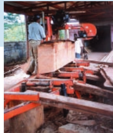
Modèle de scie mobile de plus en plus fréquent au Cameroun. Ici, une machine en activité dans la région de Bertoua. This type of mobile saw is increasingly common in Cameroon. The photograph shows the machine in use in the Bertoua region. Photo F. Pinta.
