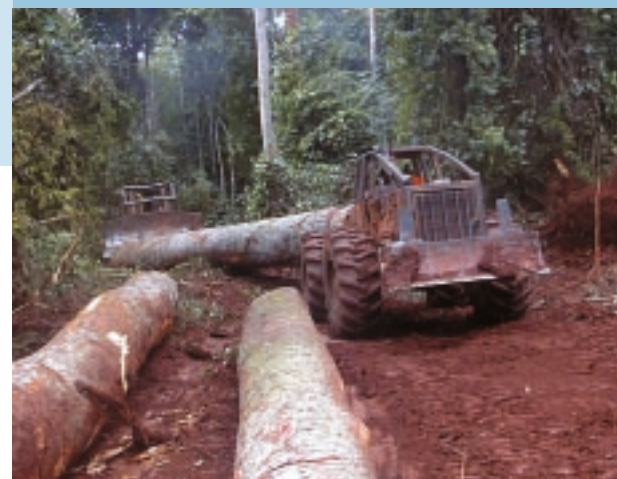
Sortie sur parc d'une grosse bille : le tracteur à roue tire et le D7 pousse. Cameroun. Pulling and pushing a large log out of a timber yard. Cameroon. Photo Jean-Michel Borie.
