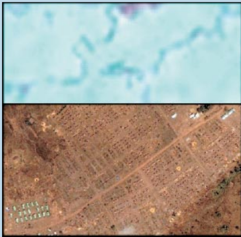
Figure 2. Superposition sur le camp de Katkama d'un extrait d'image Spot (résolution 20 m), en haut, avec un extrait d'image Ikonos (résolution 1 m), en bas. Extract of a Spot image (20 m resolution) superimposed over the Katkama camp (above), with an extract from the Ikonos image (1 m resolution) below.
