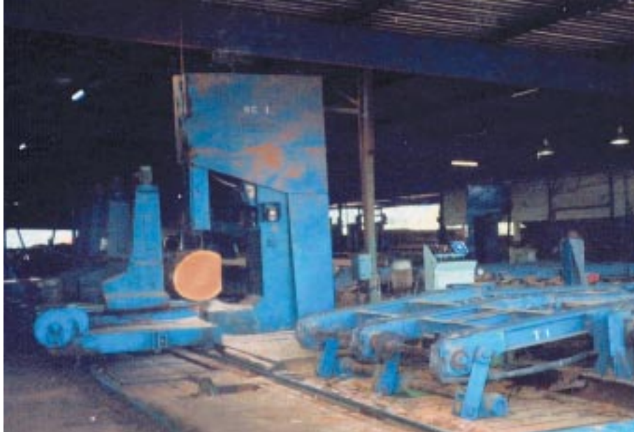
Scie de tête Primulini. Primulini head-saw. Photo C. Daigremont.
