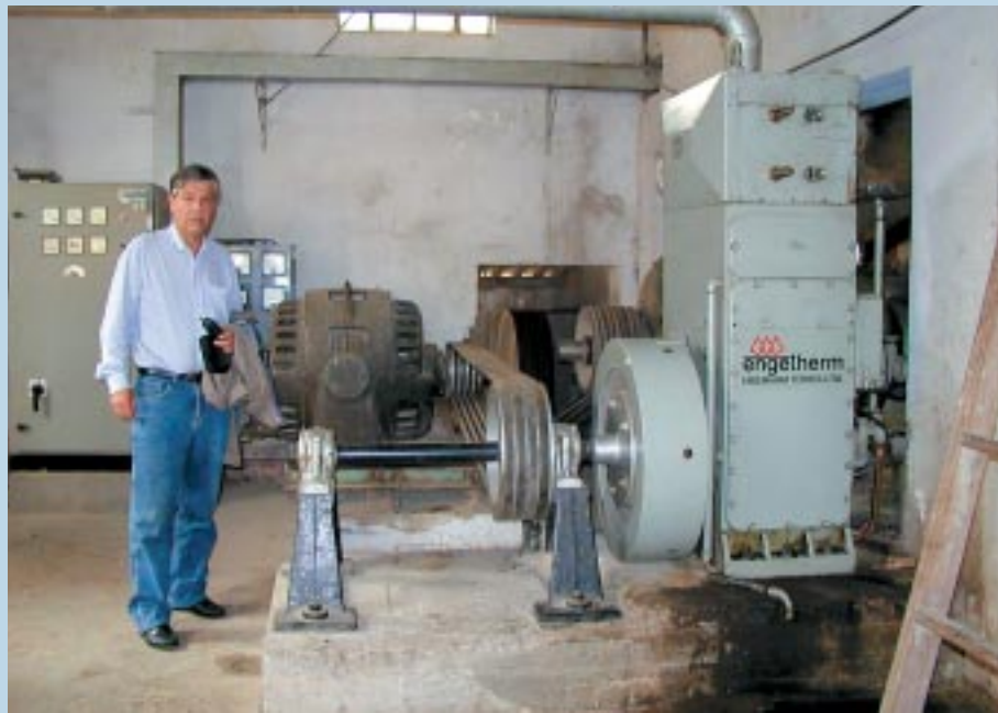
Moteur à vapeur Engetherm. Engetherm steam donkey. Photo A. Napoli.
