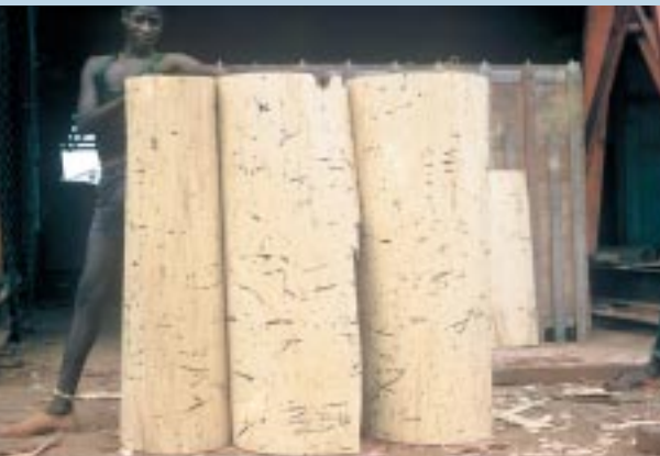
Photo 10. Déroulages d'obeché gravement altérés par des piqûres noires. Serious black spot damage in rotary-cut obeche wood. Photo M. Fougerousse.
