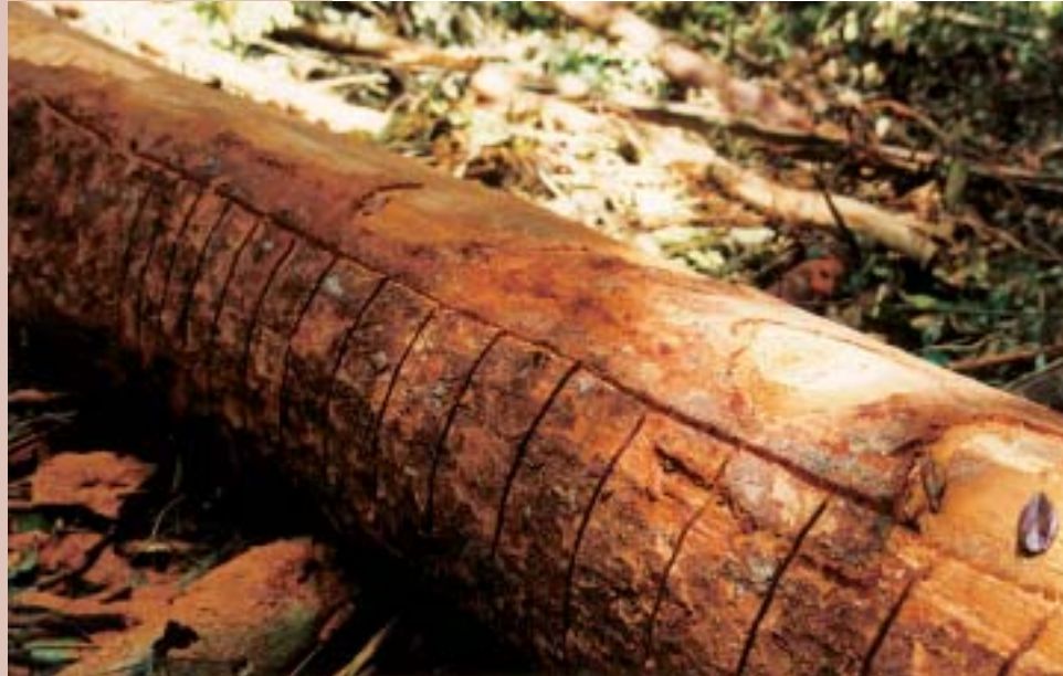
Transformation d'une grume en équarri : une série d'entailles espacées de 10 à 15 cm est réalisée à la perpendiculaire de deux amorces qui ont été tracées dans la longueur de la grume. Photo P. Langbour.
