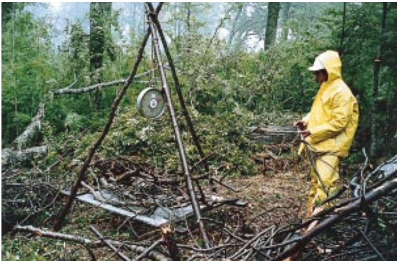
Foto 5. Algunas partes se pesan (aquí, las ramillas) para luego tomar muestras que serán analizadas en el laboratorio (tasa de humedad, tasa de carbono). Certains compartiments sont pesés (ici, les petites branches), puis des échantillons sont prélevés pour être analysés au laboratoire (taux d'humidité, taux de carbone).
