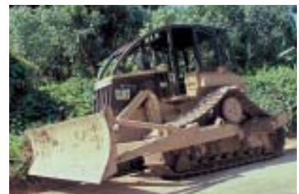
Débardeur à chenilles utilisé pour l'extraction dans une exploitation à faible impact. Caterpillar transporter used for extraction at a low-impact logging site.
