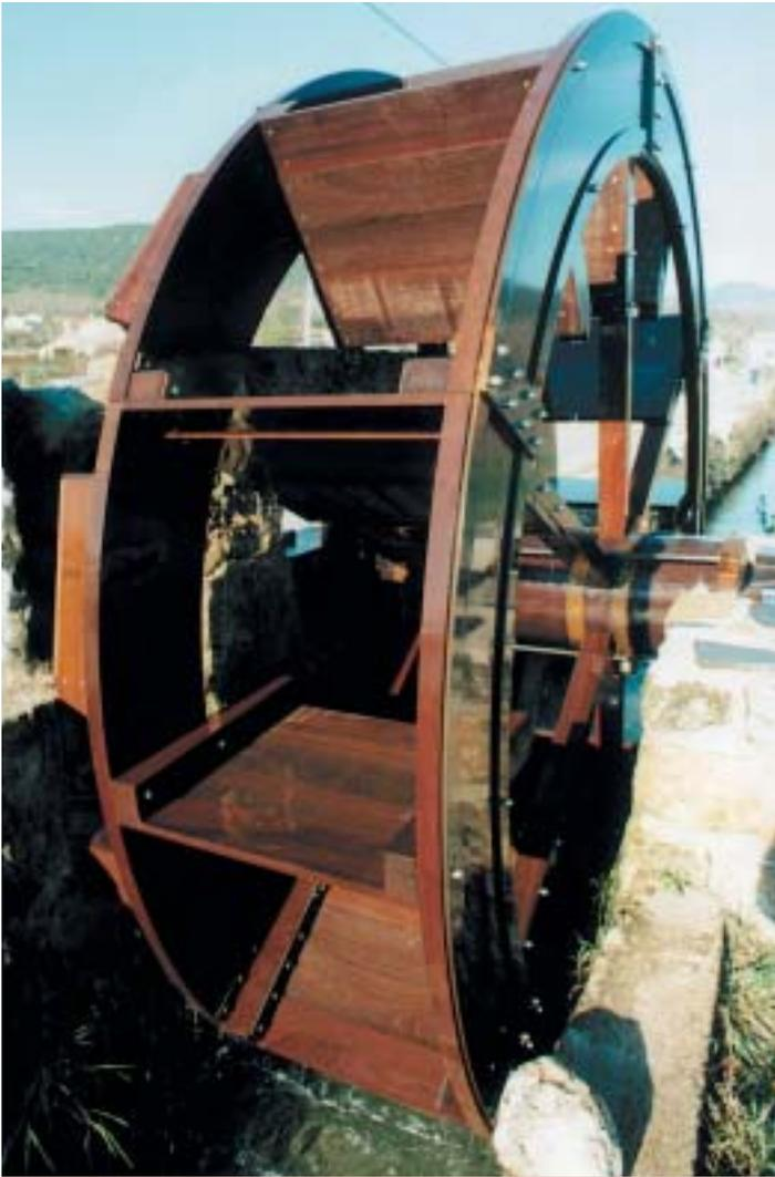
Le courant d'eau entraîne les pales et anime la roue. Des godets fixés sur les jantes déversent l'eau successivement dans un réservoir surélevé.
